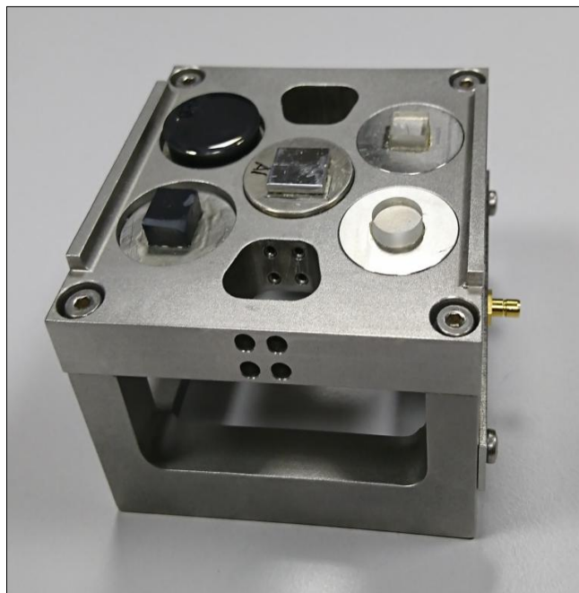
Standard Probenhalter des ZHN für fünf Proben. Er hat eine isolierte Oberseite und einen Anschluss für Widerstandsmessungen zwischen (leitfähiger) Spitze und Probe
