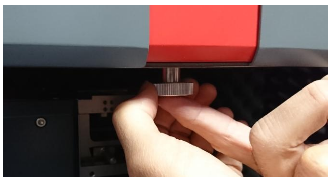
Werkzeug zum Spitzenwechsel ohne zusätzliche Schutzmaßnahmen
